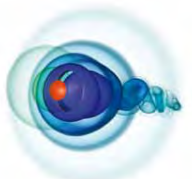
Volumenvisualisierung des Dichtefelds der Strömung um ein Kugelhinderniss mit einem Higher-Order-Raycasting Ansatz.
